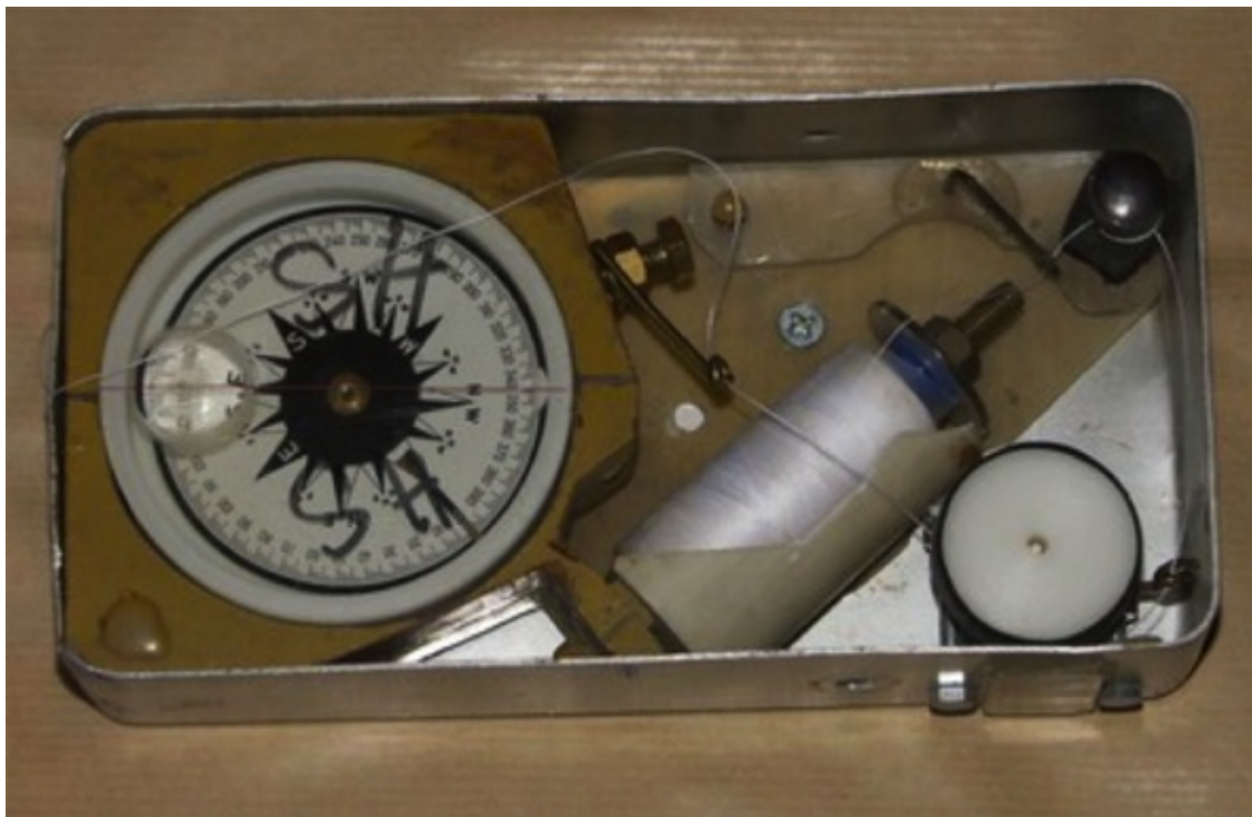
Figure 1- Topofil Vulcain (1970) : distance, azimuth et inclinaison dans un appareil compact. L'ancêtre mécanique (et analogique) du DistoX ?
