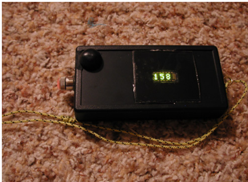
Figure 3- Un compas et clino digital : le SAP (Shetland Attack Pony), il faut encore recopier la mesure, et un disto laser indépendant doit être utilisé.
