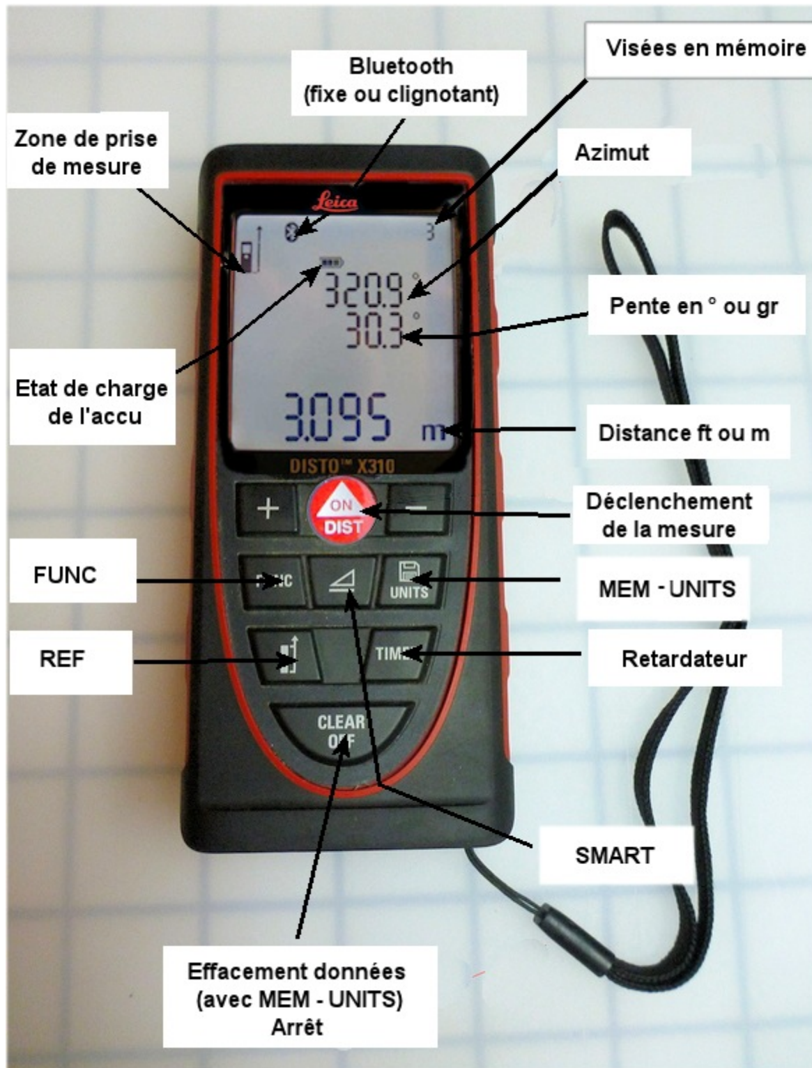
Figure 5- Ecran et clavier du DistoX2
