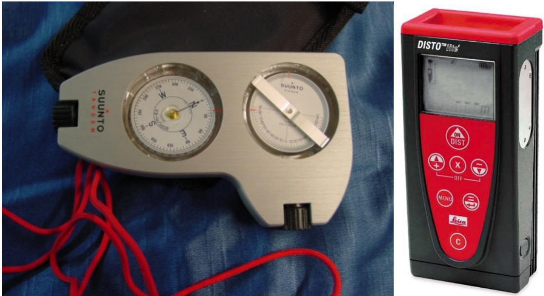
Figure 2- Compas et clino combinés : le Tandem de Suunto, utilisé en association avec un distancemètre laser.
